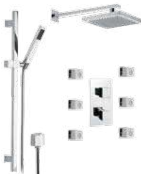
OX23613Z Set doccia con soffione a pioggia quadrato 20x20 cm con getti anticalcare e braccio 30 cm, saliscendi lusso con doccetta ad 1 funzione, attacco presa acqua tipo quadrato pesante, miscelatore con deviatore 3 vie e 7 posizioni e 6 getti anticalcare. Tutto in ottone cromato. Shower set with squared shower head 20x20 cm with antilimestone rain jet and arm 30 cm, deluxe sliding rail with hand shower 1 function, water punch connector squared and heavy type, shower mixer with 3 ways diverter and 7 positions and 6 jets antilimestone. All in c.p. brass.
