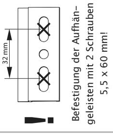
**Befestigung der Aufhängeleisten mit 2 Schrauben 5,5 x 60 mm!**
