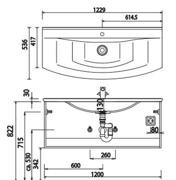
Bei Waschtischanlagen mit Befestigungsschrauben müssen die Maße zum Bohren vor Ort, nach dem Auflegen des Waschtisches auf den Unterschrank, angezeichnet werden.
