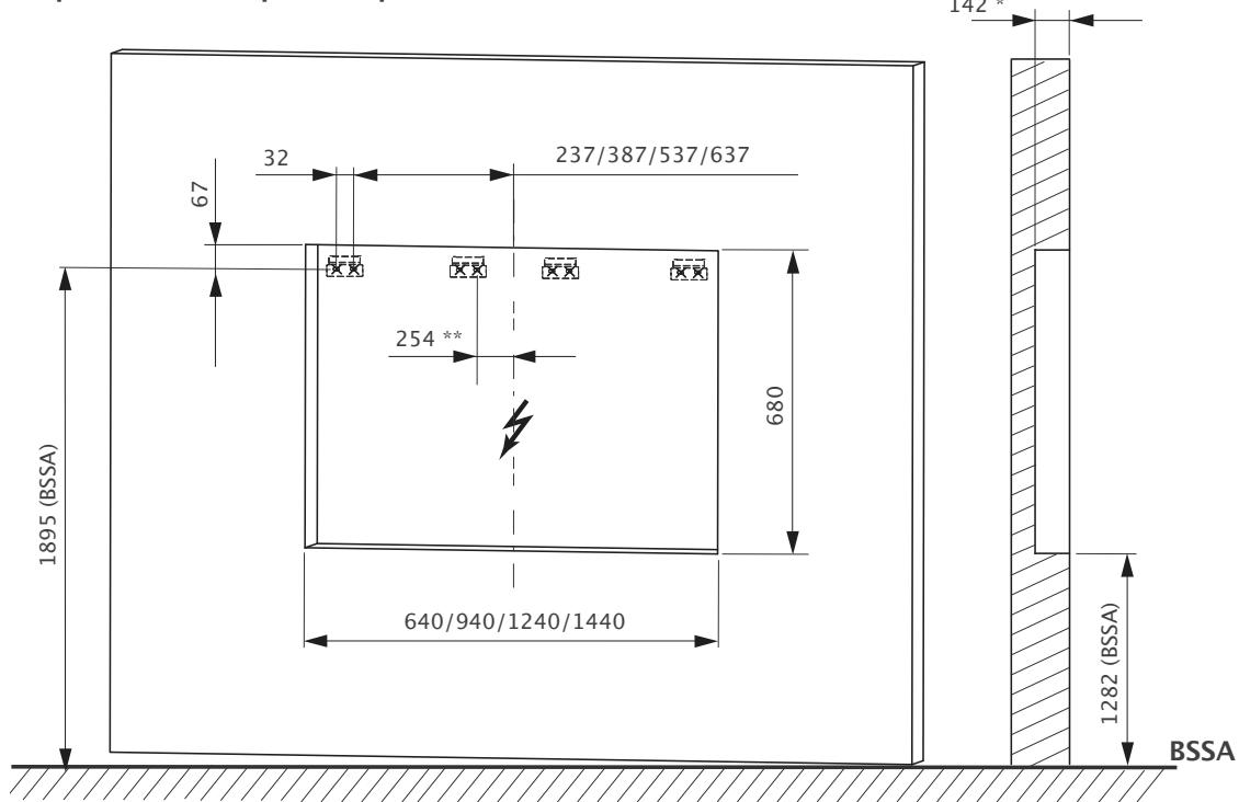
x = position de perçage dans le mur
