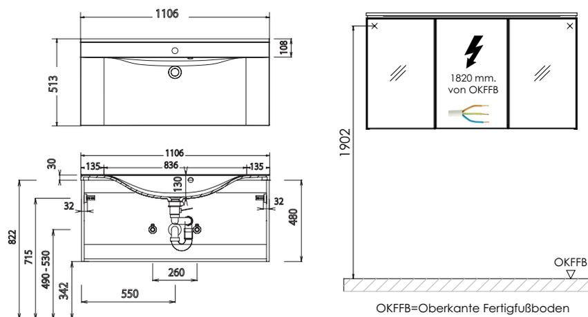
Bei Waschtischanlagen mit Befestigungsschrauben müssen die Maße zum Bohren vor Ort, nach dem Auflegen des Waschtisches auf den Unterschrank, angezeichnet werden.
