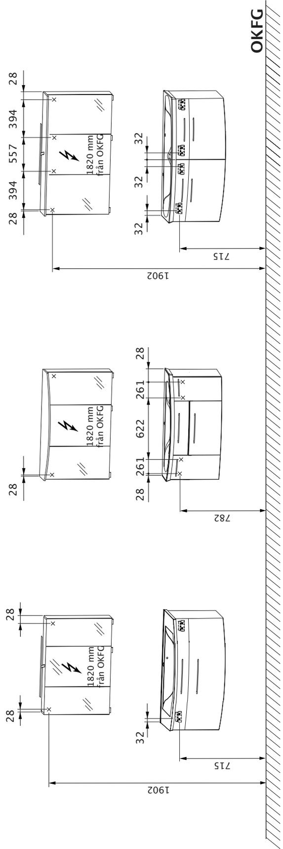
OKFG = Ovankant färdigt golv x = Fastsättning på list x = Fastsättning på skruvkrok x = Borrposition i vägg
