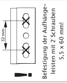
Befestigung der Aufhängeleisten mit 2 Schrauben 5,5 x 60 mm!
