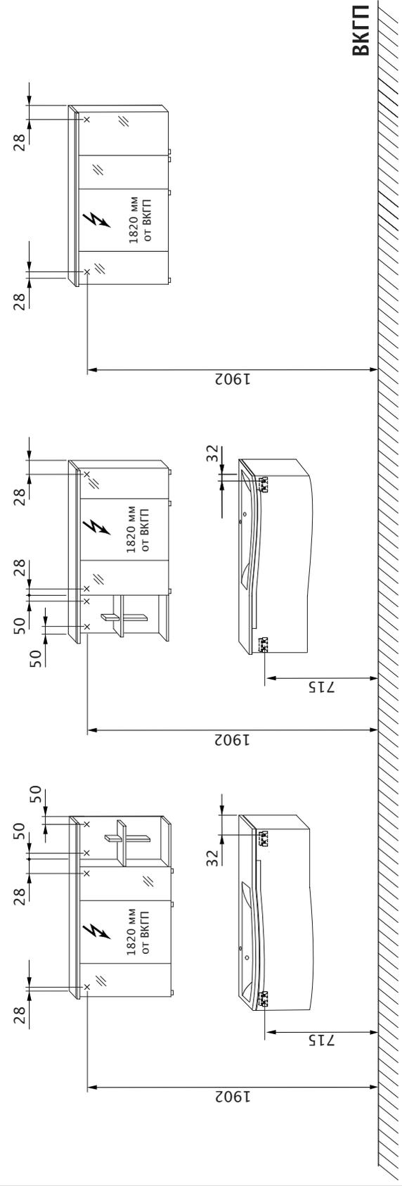
ВКГП = верхний край готового пола    = крепление на шурупах с крючками    x = позиция отверстия в стене
