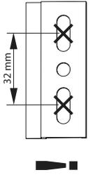
Fixation des barrettes de suspension à l'aide de 2 vis !
