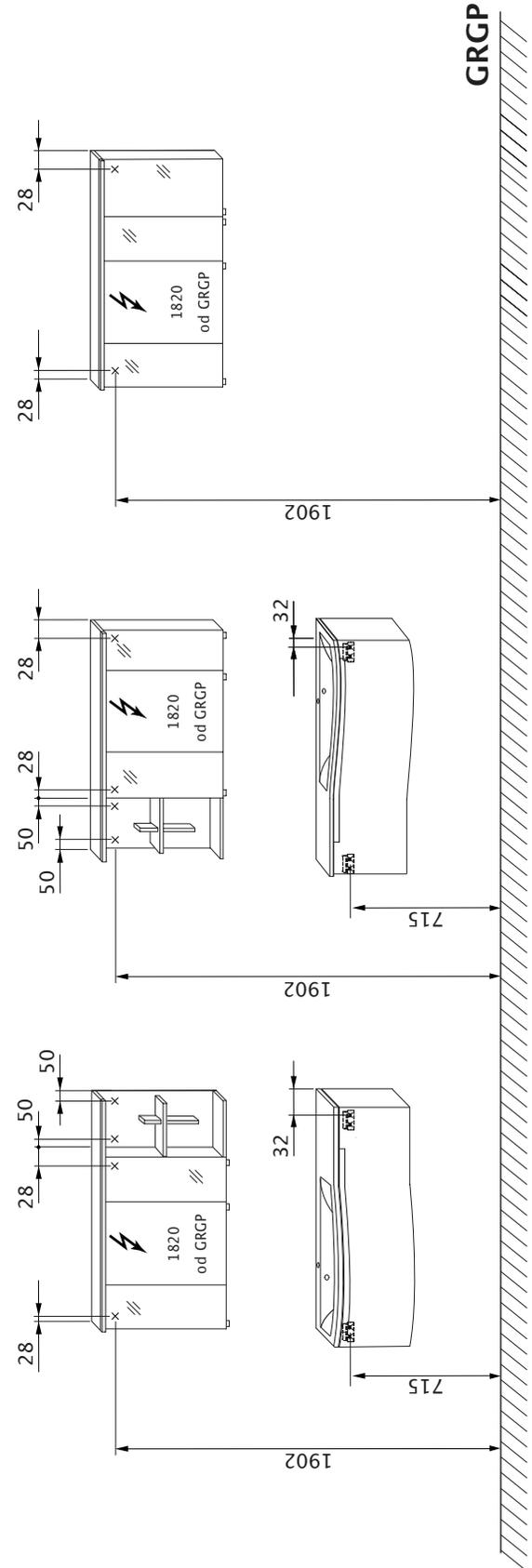
GRGP = Gornji rub gotovog poda    = Pričvršćivanje na letvici    x = Pričvršćivanje na kuki s navojem    x = Položaj bušenja na zidu
