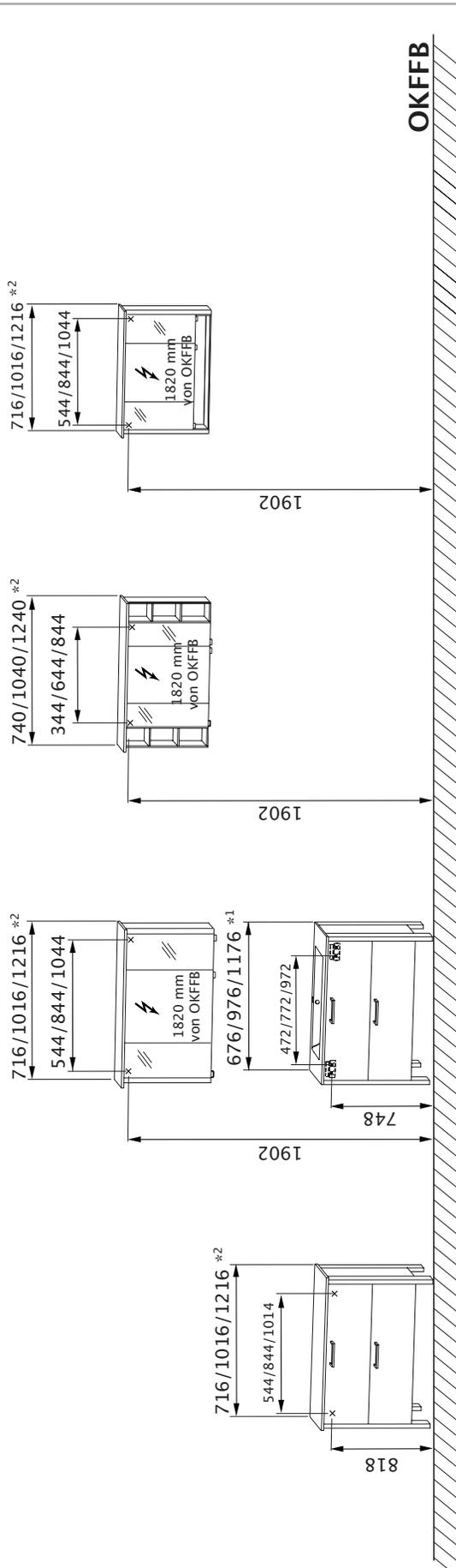
OKFFB = Oberkante Fertigfußboden \*1 WTU mit Dekorstollen, ohne Waschtisch \*2 Maße mit Abdeckplatte x = Bohrposition in Wand
