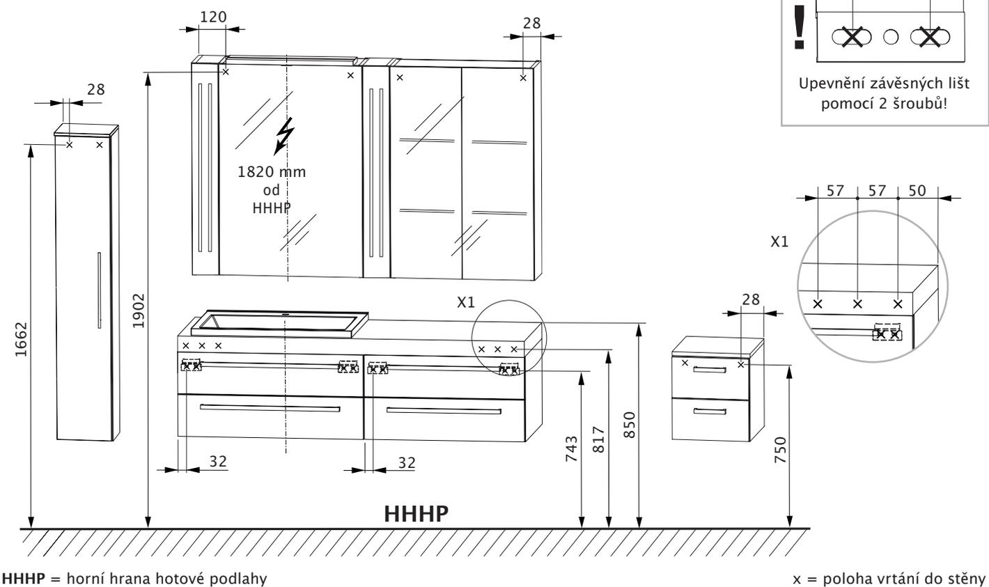
PŘEHLED ROZMĚRŮ U NASAZOVACÍHO MYCÍHO STOLU (V MM)
