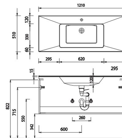
Bei Waschtischanlagen mit Befestigungsschrauben müssen die Maße zum Bohren vor Ort, nach dem Auflegen des Waschtisches auf den Unterschrank, angezeichnet werden.
