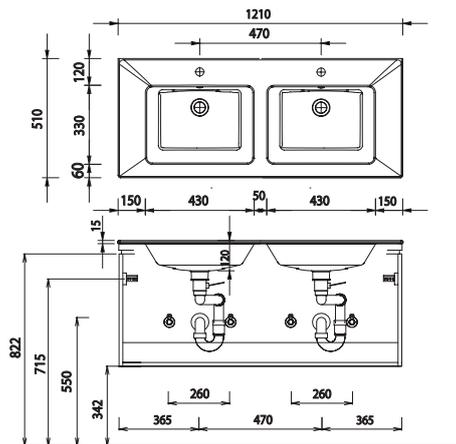
Bei Waschtisanlagen mit Befestigungsschrauben müssen die Maße zum Bohren vor Ort, nach dem Auflegen des Waschtisches auf den Unterschrank, angezeichnet werden.
