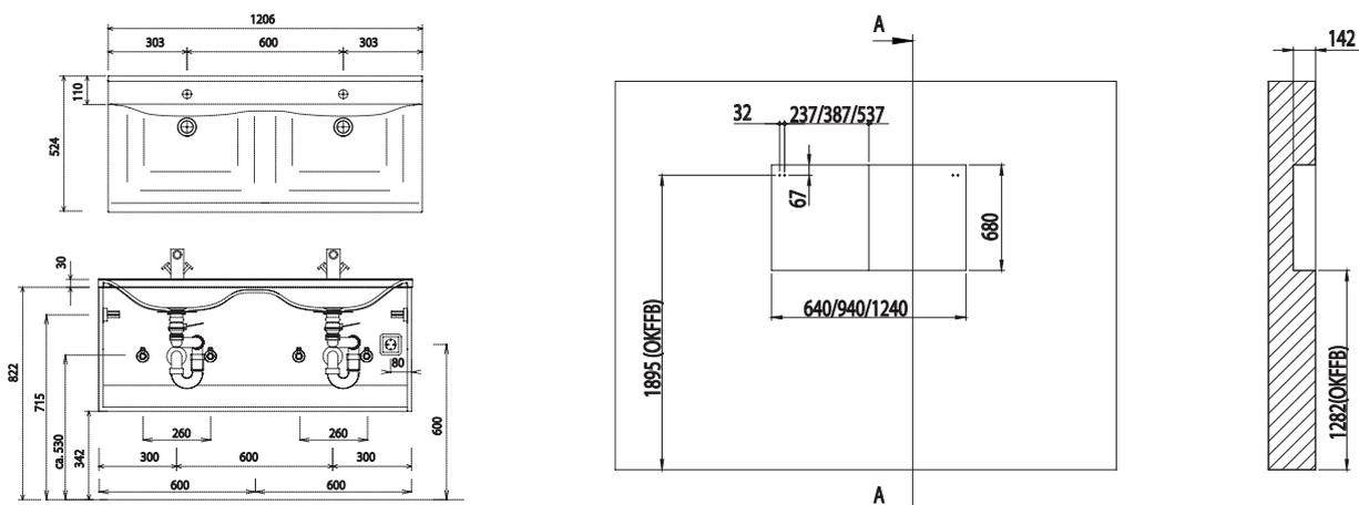
Bei Waschtisanlagen mit Befestigungsschrauben müssen die Maße zum Bohren vor Ort, nach dem Auflegen des Waschtisches auf den Unterschrank, angezeichnet werden.
